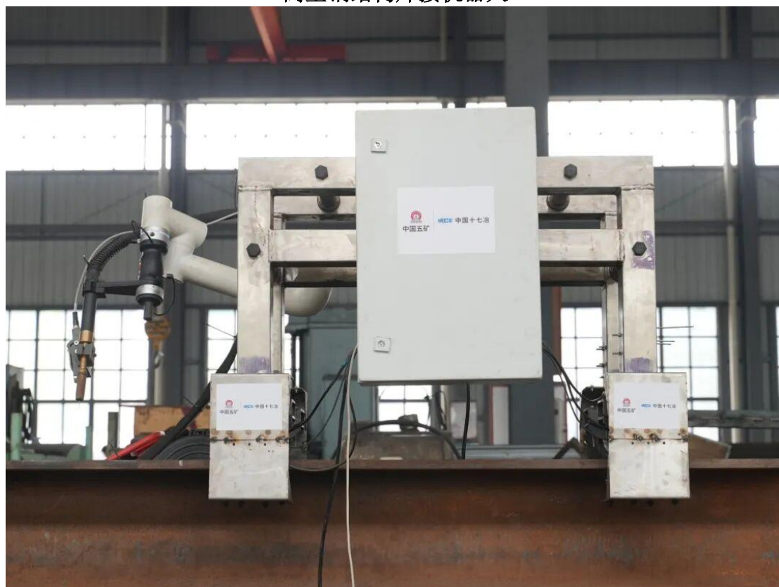
高空钢结构焊接机器人
